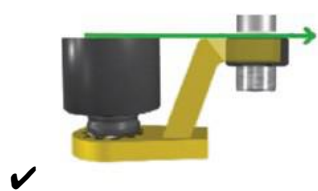
图6.5（正确的反力臂长度）
