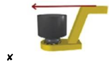
图6.4（错误的反力臂高度）
