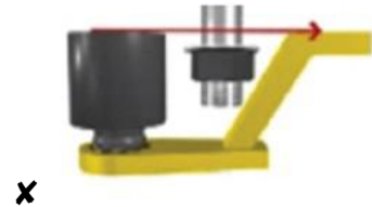
图6.7（错误的反力臂长度）
