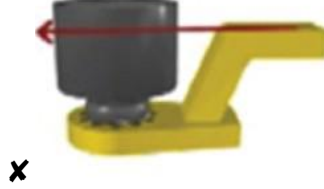
图6.6（错误的反力臂长度）
