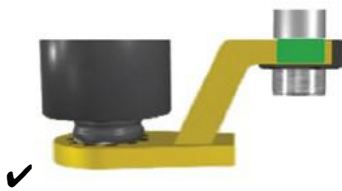
图6.8（正确的反力支点）
