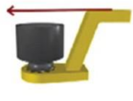
图6.4（错误的反力臂高度）
